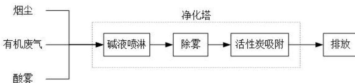
图 2 废气处理工艺流程图
